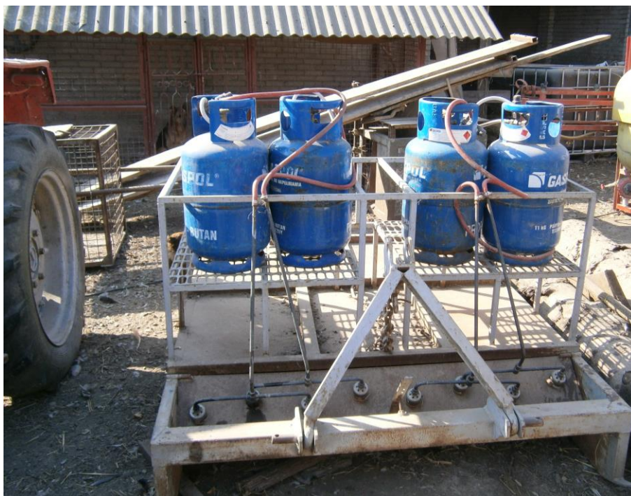
Fot.1 Wypalacz płomieniowy do zwalczania chwastów w gospodarstwie ekologicznym
