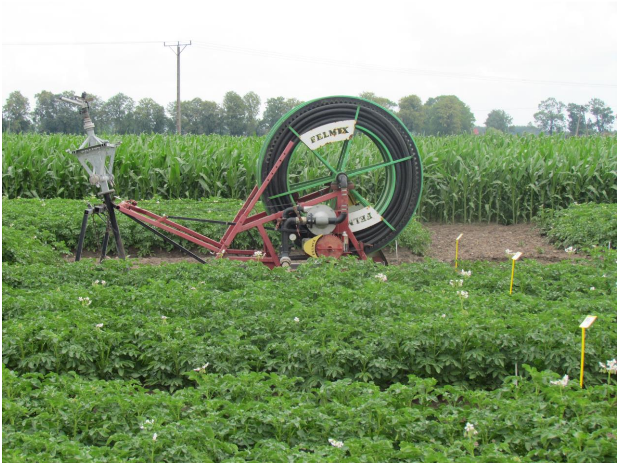
Rysunek 2. deszczownia szpulowa wyposażona w działko zraszające
